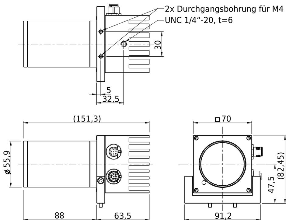
Abb. 3.2: Gesamtabmessungen des *rc\_randomdot White*
